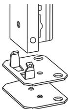
Unterlegplatte für Doppel-Klemmfuß
