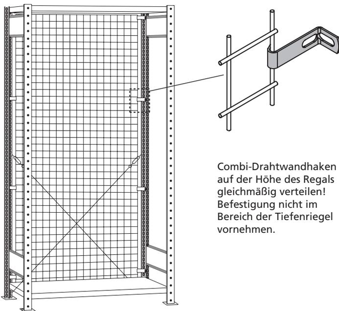
Combi-Drahtwandhaken auf der Höhe des Regals gleichmäßig verteilen! Befestigung nicht im Bereich der Tiefenriegel vornehmen.
