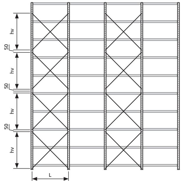
$h_v = 1.200 \text{ mm}$  für  $L = 750 \text{ mm}$
