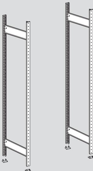
**2 Einsetzen der Längsriegel**
