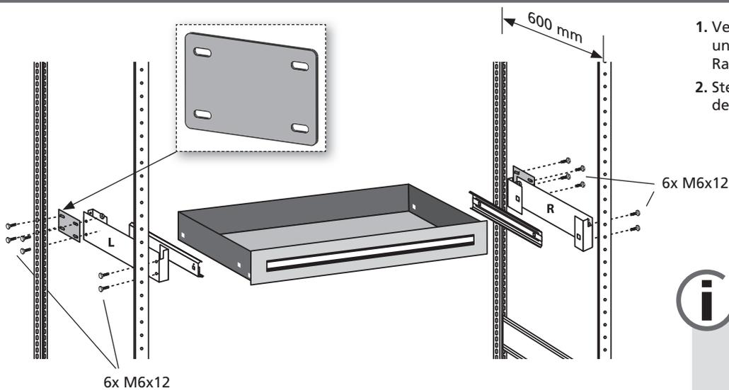
1. Verschrauben Sie die Halterungen und die Adapter mit dem T-Profil-Rahmen.
