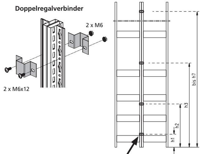
Einbauhöhen bei Montagen mit weiteren Systemteilen abgleichen. (z.B. Kreuzstreben, Fachböden) Höhenangaben dürfen bei Bauteilkollisionen abweichen. Verbinder können nach oben oder unten verschoben werden, ggf. Rücksprache mit Schulte Lagertechnik.
