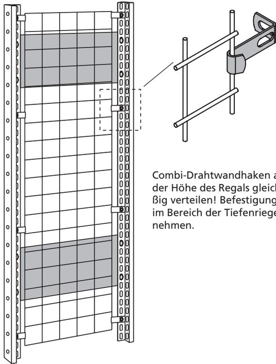
Combi-Drahtwandhaken auf der Höhe des Regals gleichmäßig verteilen! Befestigung nicht im Bereich der Tiefenriegel vornehmen.
