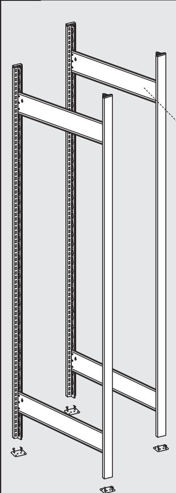
**A Einsetzen der Tiefenriegel in T-Profile**
