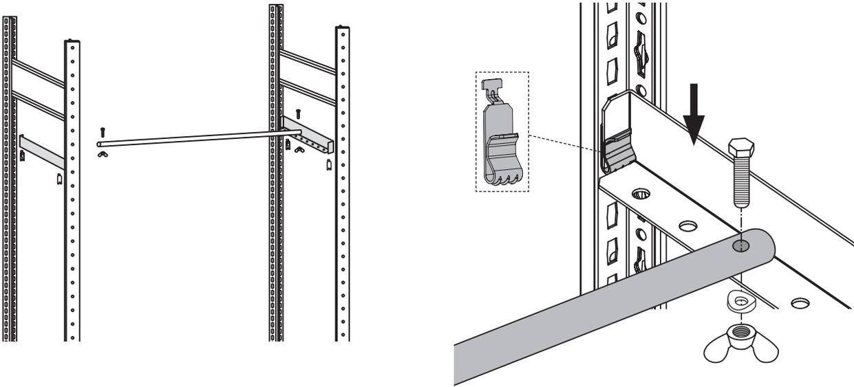
Einhängen der Fachbodenträger in die T-Profile
