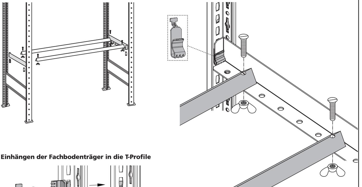
Einhängen der Fachbodenträger in die T-Profile
