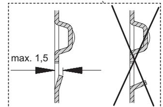
**2 Einsetzen des Fachbodenträgers Typ 150 und der Fachböden**
