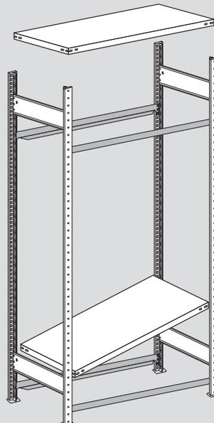
**3 Einsetzen der Fachboden-träger und Fachböden**
